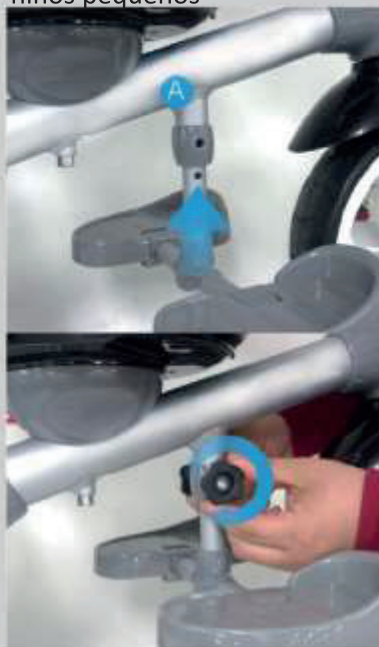
Instalación del apoyo para niños pequeños
